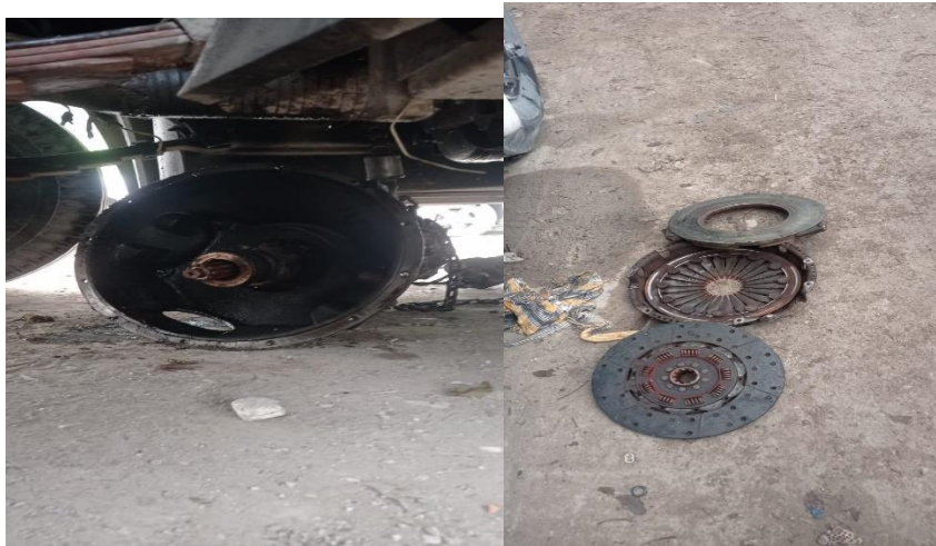
Reparación de discos a los camiones.
